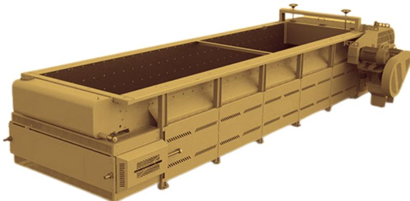
Os alimentadores de sapata são uma solução confiável para extrair ou alimentar minérios úmidos, pegajosos, secos ou mesmo congelados. A diversidade do alimentador de sapata pode ser encontrada em todo o circuito de processamento mineral, adaptando-se a diferentes aplicações com projetos robustos e alto tempo de atividade para uma operação mais eficiente.
